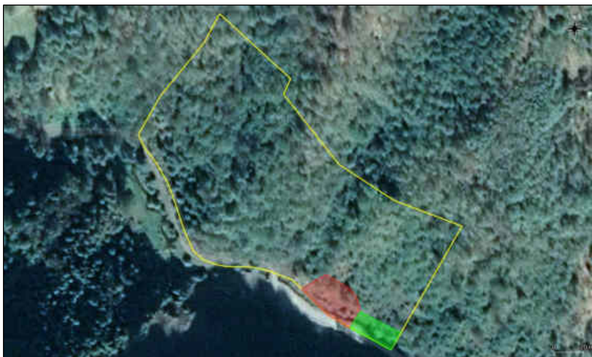
Figura nr. 2. – Aspect privind amplasarea organizării de șantier (poligon de culoare verde), a haldei de depozitare a solului (poligon de culoare roșie) în cadrul amplasamentului vizat de implementarea proiectului (poligon de culoare galbenă)
