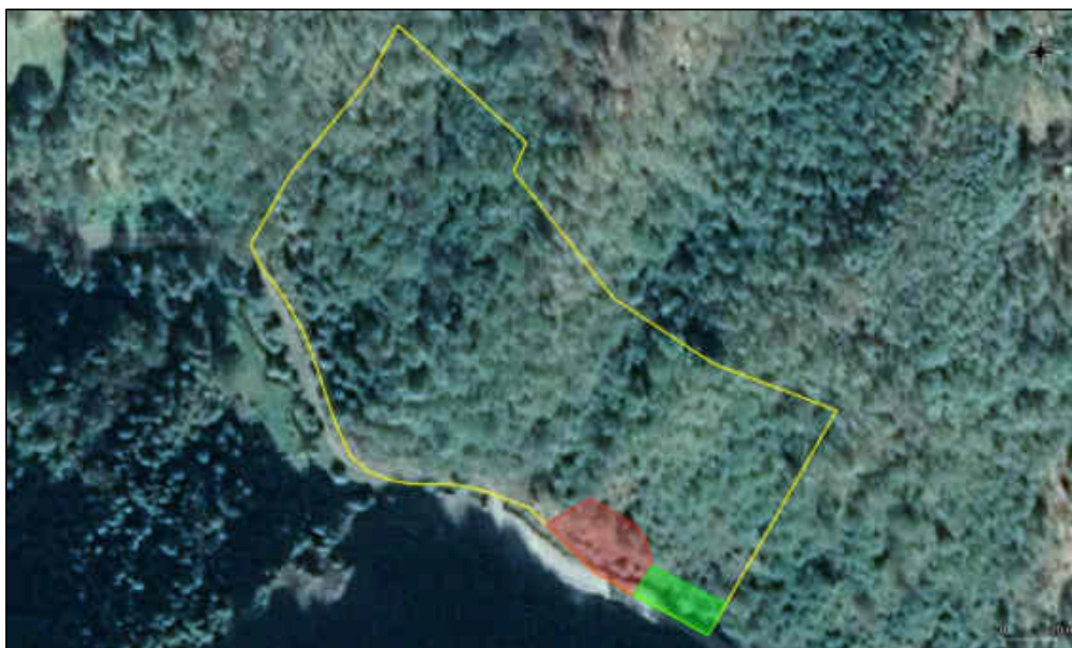
Figura nr. 4. – Aspect privind amplasarea organizării de șantier (poligon de culoare verde), a haldei de depozitare a solului (poligon de culoare roșie) în cadrul amplasamentului vizat de implementarea proiectului (poligon de culoare galbenă)
